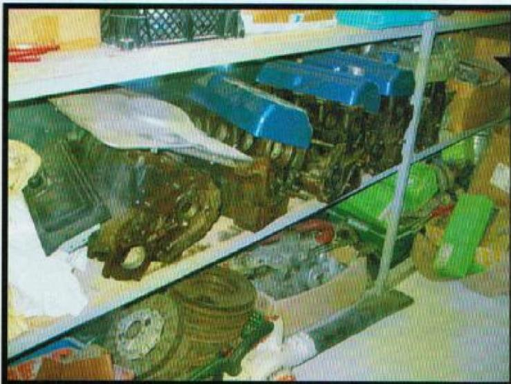
Une série de carters cylindres de moteur 1397 cm<sup>3</sup>. Il n'y a pas de différence entre le bloc de 5 Alpine Turbo et celui de la Turbo, sauf les paliers d'arbre à cames, qui sont bagués.
