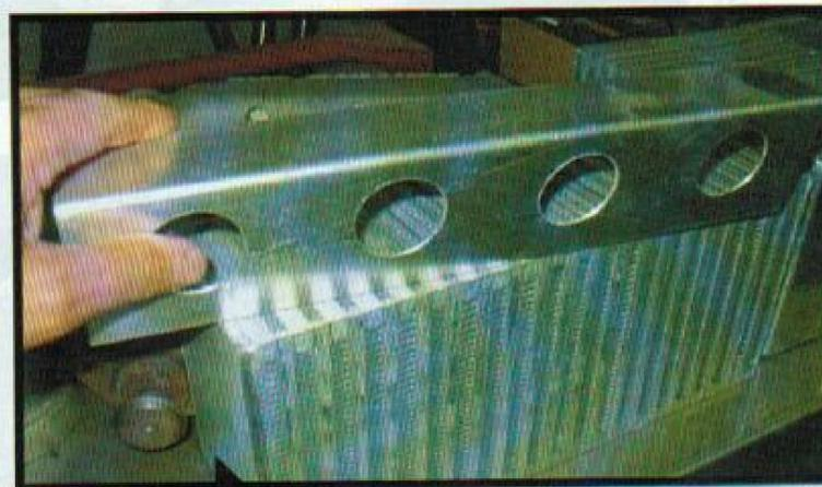
« Nous refabriquons aussi des radiateurs en aluminium. Nous soustraisons le faisceau, comme pour les échangeurs, Ensuite on rajoute des plaques selon les désirs du client : plus ou moins de refroidissement. »
