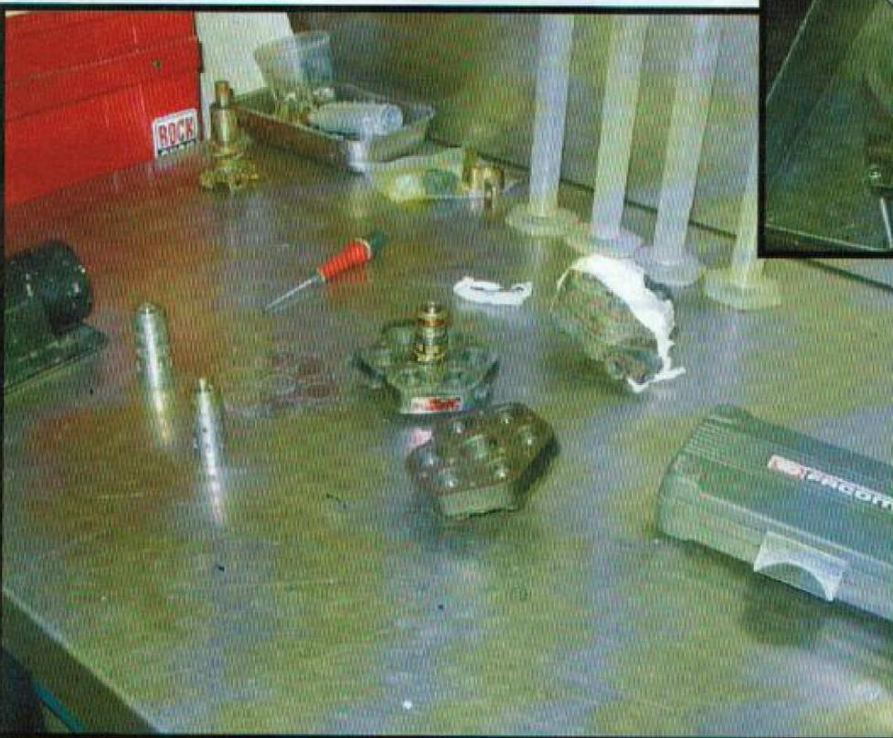
Cylindre du doseur distributeur. Il y a des joints toriques à remplacer. Un clinquant en inox (à gauche) est également positionné entre les deux faces du doseur.
