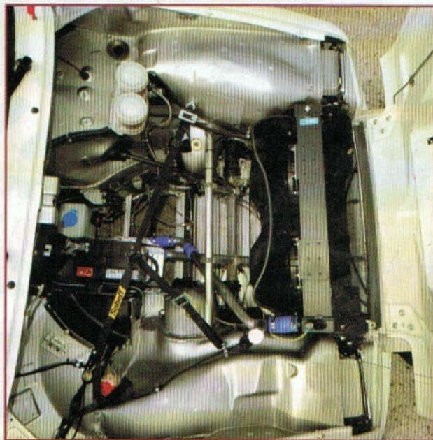
Le 4 cylindres turbocompressé de 1397 cm 3 développe ici 315 ch et un couple de 37 mkg à 4000 tr/min. En version "Cévennes" cette mécanique fournissait environ 210/220 ch. ▼
