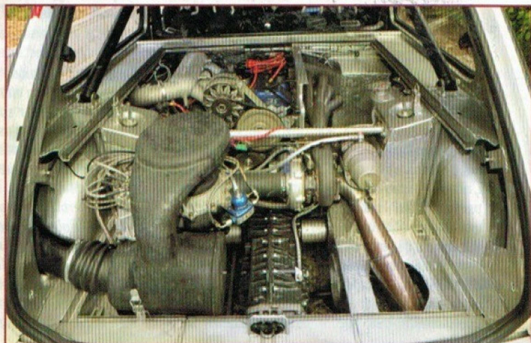
Le 4 cylindres turbocompressé de 1397 cm 3 développe ici 315 ch et un couple de 37 mkg à 4000 tr/min. En version "Cévennes" cette mécanique fournissait environ 210/220 ch. ▼
