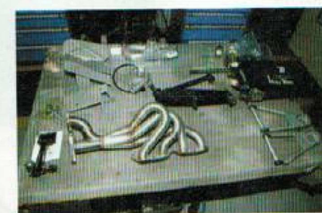
Le train arrière de la Maxi 5 sans son combiné ressort-amortisseur.
