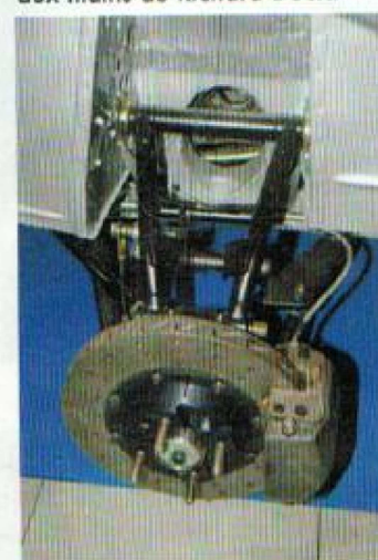
Le train arrière de la Maxi 5 sans son combiné ressort-amortisseur.
