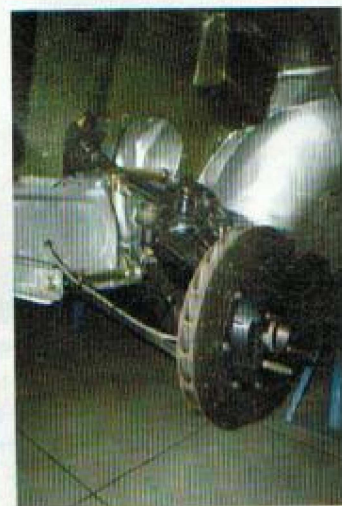
Le train avant de la Maxi 5 en cours d'assemblage.
