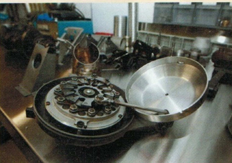
Les entrailles du DPV, sorte d'obturateur commandé par l'accélérateur destiné à conserver la vitesse du turbo et à diminuer le temps de réponse.
