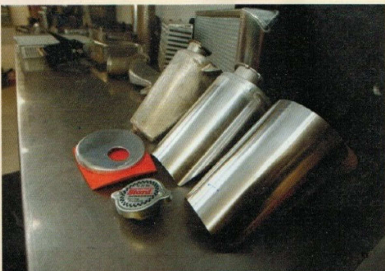
Stéphane et Guy réalisent à la main des boîtes à eau neuves en aluminium rigoureusement identiques à celle de Renault Sport.
