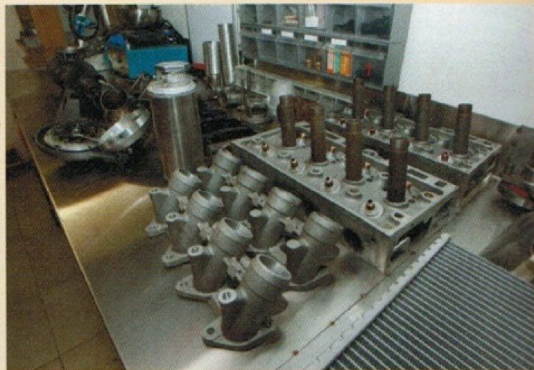
Alignées, les culasses attendent d'être montées. Au premier plan, des pipes d'admission neuves, dont certaines encore brutes de fonderie avec les perçages d'injecteurs pas encore usinés.
